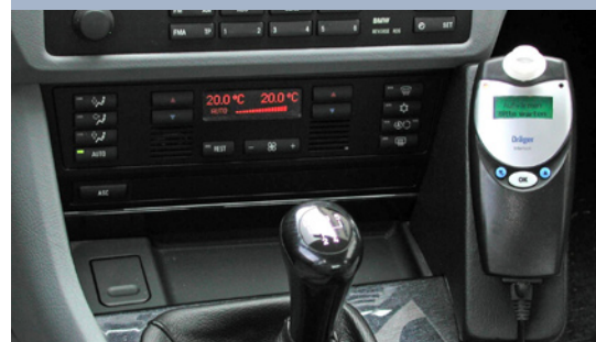
Dräger Interlock XT monterad vid förarplatsen
